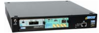
Мини-система многоканального радиомониторинга TORNADO-RxMTCA® с AMC-модулем РМ/ЦОС TORNADO-ARX1® и коммуникационным AMC-модулем T/AX-DSFPX на базе мини-шасси MicroTCA®
