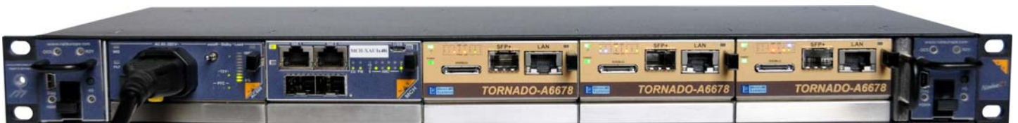
Компактная модульная система ЦОС/ПЛИС TORNADO-MTCA® с тремя F/S AMC-модулями ЦОС/ПЛИС TORNADO-A6678 на базе шести-слотового 19" 1U шасси MicroTCA® с коммутатором 10GbE кросс-панели
