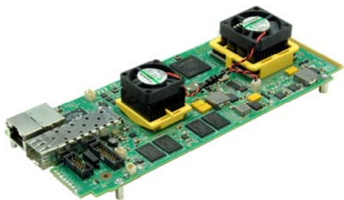
АМС модуль TORNADO-A6678 как S/A контроллер
